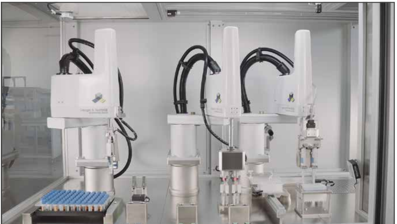
El sistema de procesamiento de laboratorio PT600 para la transferencia de muestras utiliza un robot Cobra 450 de OMRON que facilita el transporte sin contacto.
