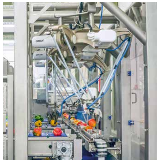
"Utilizamos tres robots de Omron, que son variantes resistentes a líquidos que se pueden limpiar a fondo".
