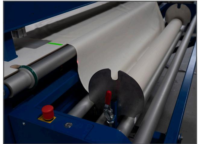
Sycade eine Lösung, bei der eine „Standard“-Rollmaschine eingesetzt wird, um Stoffrollen von Position A ab- und in Position B wieder aufzurollen. Die abgerollte Stoffbahn wird über eine Prüffläche mit einer integrierten Schneideinheit geführt, die sich innerhalb einer abgedunkelten Einheit mit Bildverarbeitungstechnologie befindet.
