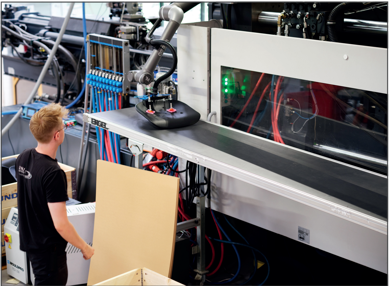
Mit dem integrierten Bildverarbeitungssystem prüft der Cobot die Etikettierung auf dem gebogenen Kunststoffteil.
