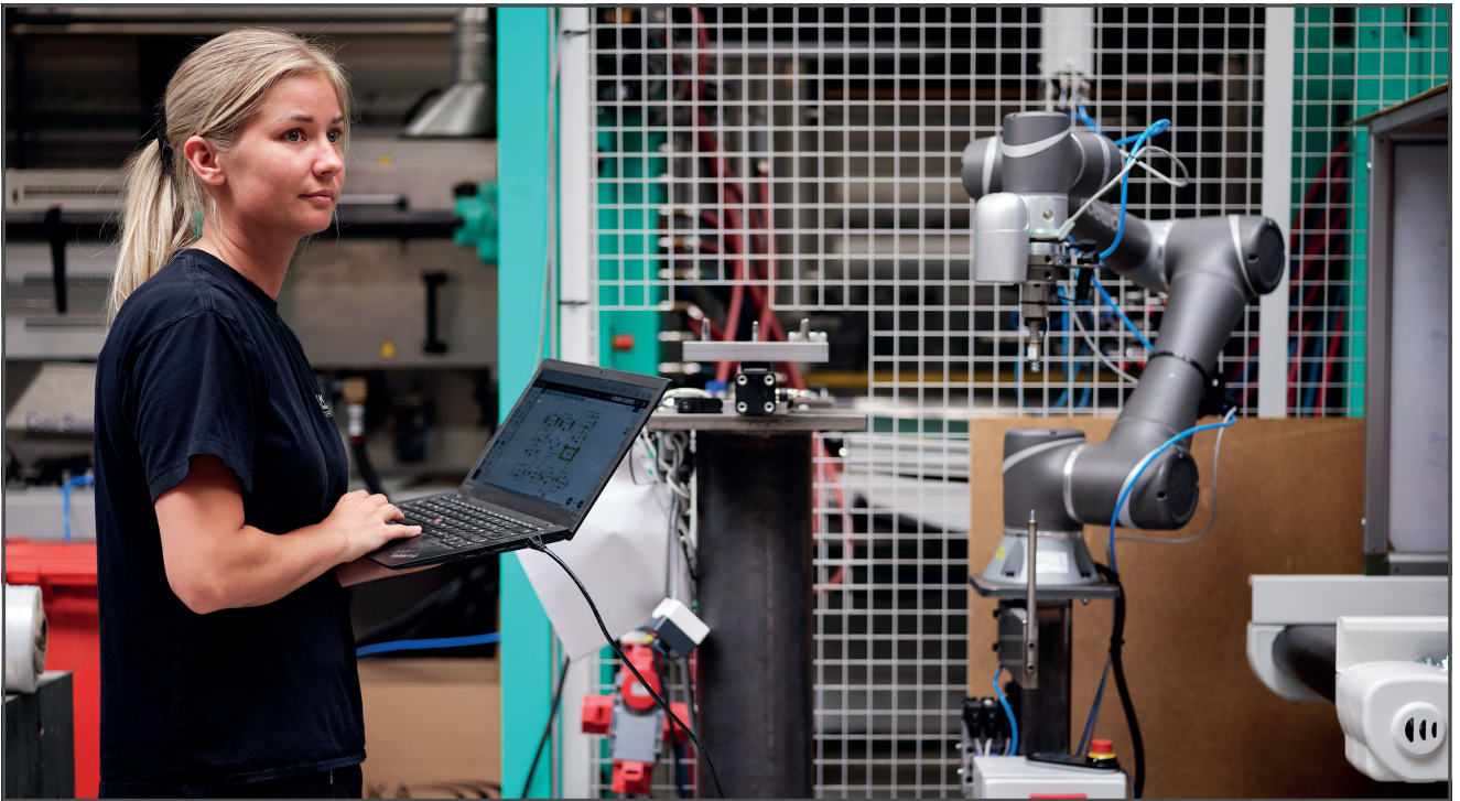
Die Hauptaufgabe der in der Qualitätssicherung eingesetzten Cobots ist die Erkennung von Anomalien, eine Aufgabe, die sie dank des Bildverarbeitungssystems OMRON Landmark unermüdlich und präzise ausführen.
