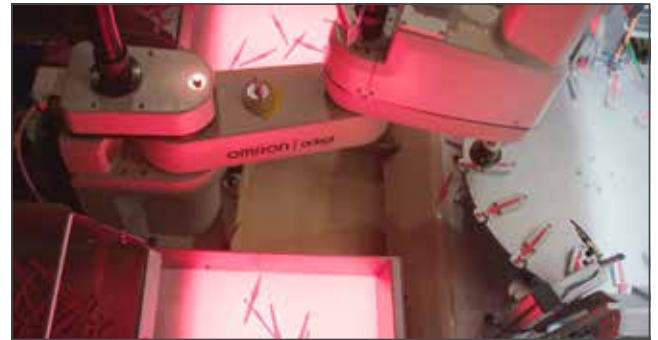
Die neue Linie erfüllt die primäre Anforderung, 300 Zahnbürstentpackungen pro Minute zu verarbeiten.
