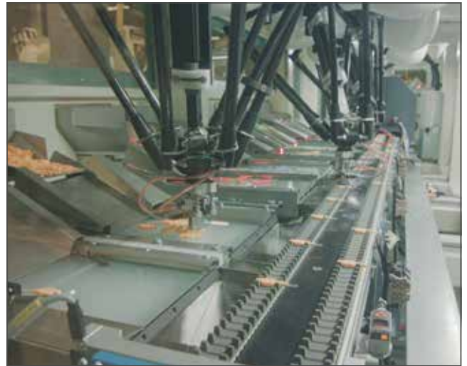
Eine Hochgeschwindigkeits-Fertigungsline, bestehend aus fünf Industrierobotern, zwei mobilen Robotern und zehn Bildverarbeitungssystemen, ermöglicht TePe nun, den Durchsatz um das 9-Fache zu erhöhen und kundenspezifische Verpackungen innerhalb von Sekunden anzupassen.
