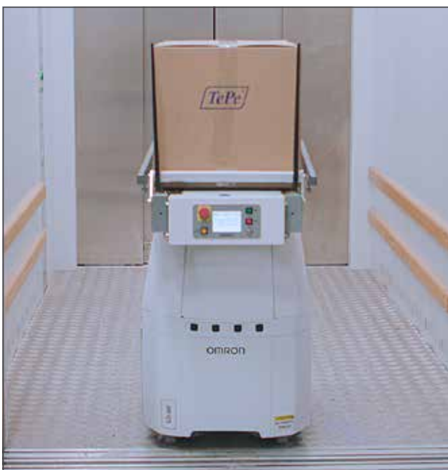
Die mobilen Roboter transportieren sowohl Gegenstände zwischen den verschiedenen Maschinen als auch vom Lager zur Fertigungslinie.
