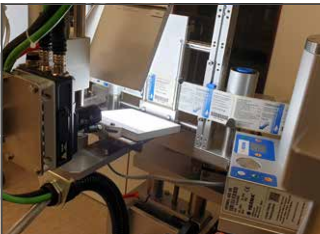
Mithilfe der FHV7 kontrolliert die HERMA-Etikettiermaschine bei Steierl-Pharma anhand des Pharmacodes die Identität des Etiketts und prüft Charge und Verfall.
