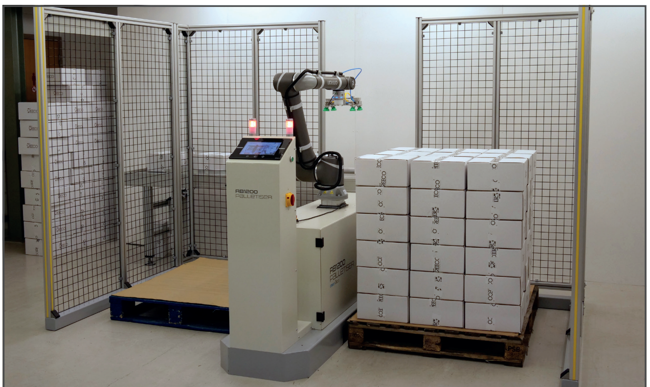
Der RB1200 ist nur 2,2 x 3,2 m. Das entspricht einer Größenreduzierung von 60 % im Vergleich zu einem typischen 4 x 4 m großen kartesischen Palettierer.
