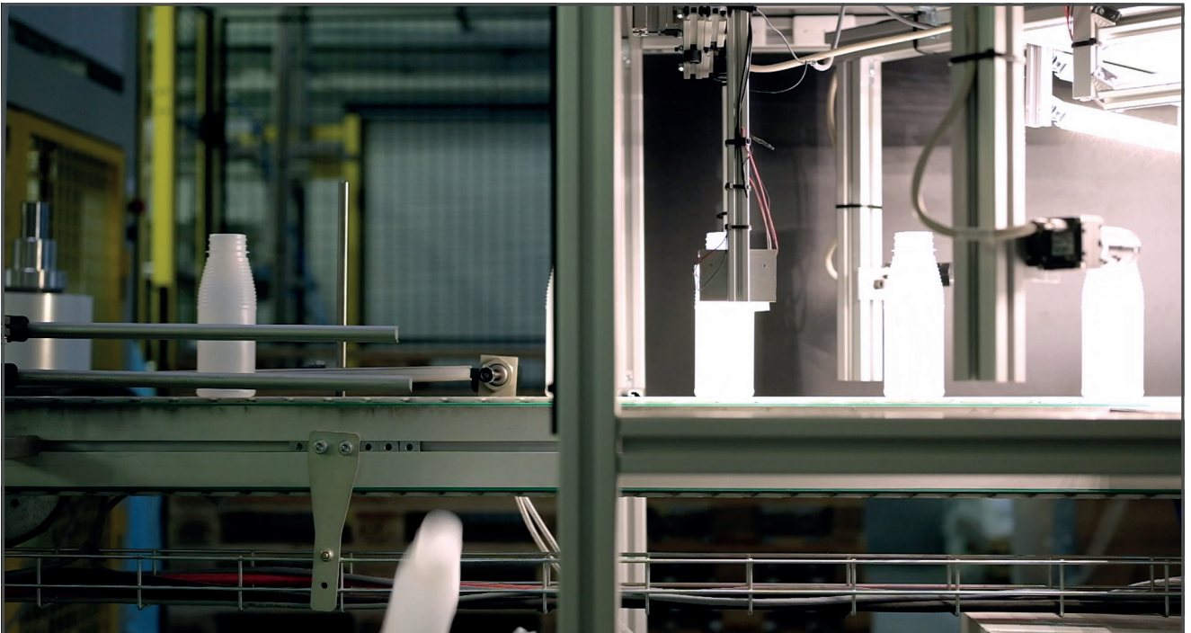
Jede Flasche, bei der ein Fehler erkannt wird, wird automatisch aussortiert.
