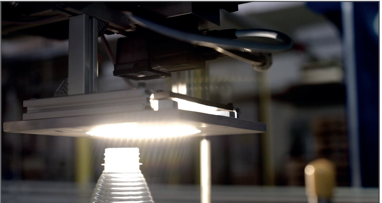
Das Omron-System wird in der Fertigungsstraße eingesetzt und umfasst Leuchten und Kameras, die in verschiedenen Winkeln angebracht sind.
