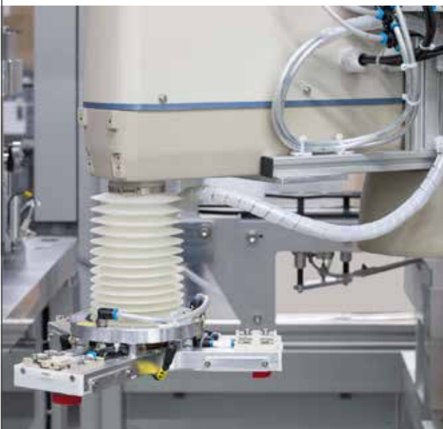
Der eCobra-Pro-Roboter unterstützt im Zusammenspiel mit leistungsstarker Kamera- und Visualisierungstechnologie sowie dreifachem Greifer die akkurate Schichtung und die präzise Montage.
