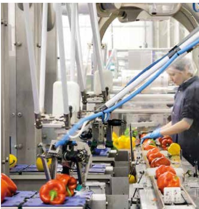
Die Roboter nehmen die Paprika auf und setzen sie in der richtigen Position und Farbreihenfolge auf das Band.
