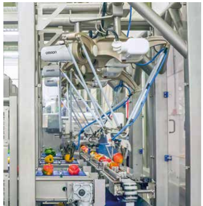
„Wir setzen drei Roboter von Omron in wasserdichter Ausführung ein, die gründlich gereinigt werden können.“
