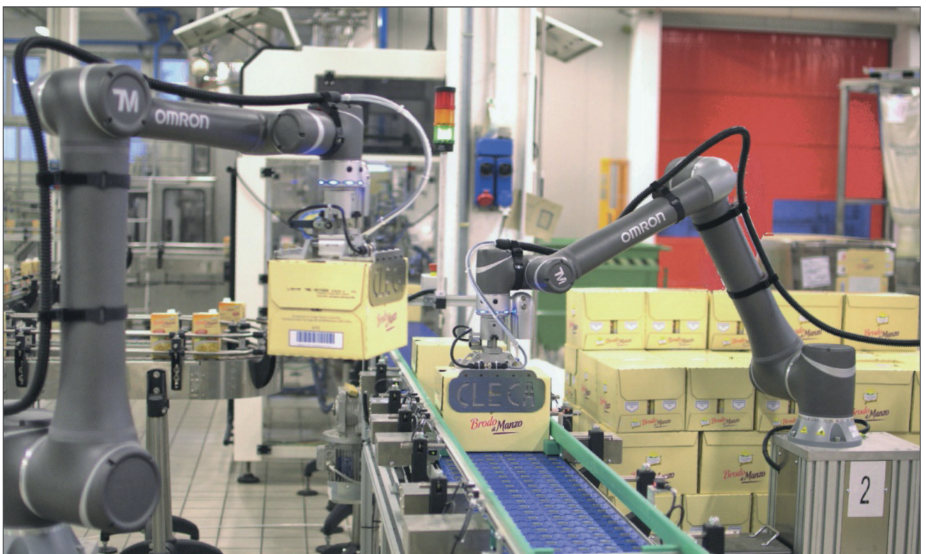
Die TM12-Cobots von OMRON haben eine Nutzlast von 12 Kilogramm und eine Reichweite von 1.300 Millimetern. Sie haben CLECA geholfen, Automatisierung und Produktivität voranzutreiben.
