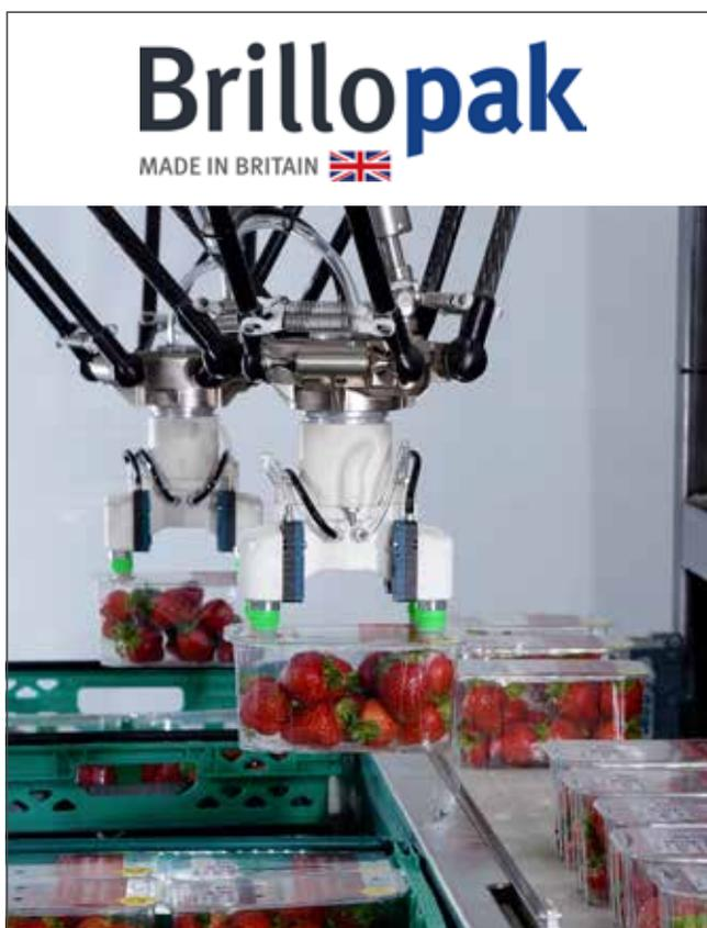
*Brillopak hat ein Universalkonzept entwickelt, mit dem sich jede Schale einzeln in die korrekte Position in der Box verladen lässt.*
