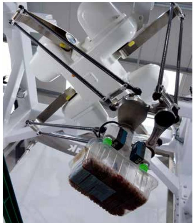
*Die PackXpert Software von Omron ermöglicht, die Reihenfolge der Positionierung und Befüllung jeder Schale individuell zu programmieren.*
