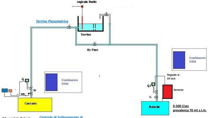
Q1- portata Balardo Q - portata Cassano v - valvola vm-valvola motorizzata Centrale di Sollevamento di Cassano Irpino
