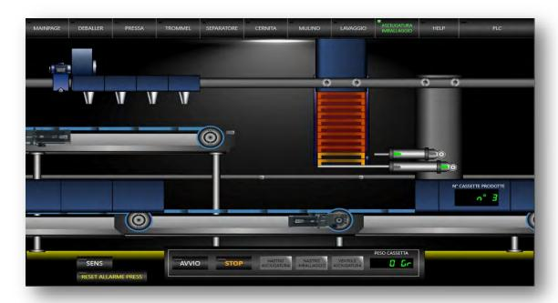
Nella simulazione l'asciugatura avviene mediante dei soffiatori che oscillando distribuiscono in modo uniforme aria calda sopra i fiocchi di PET.
