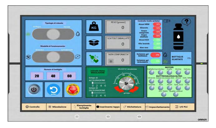
Nella pagina pannello di controllo sono inseriti tutti i pulsanti e i selettori necessari al funzionamento del ciclo di lavoro e al suo settaggio, partendo da quest'ultimi essi sono:
