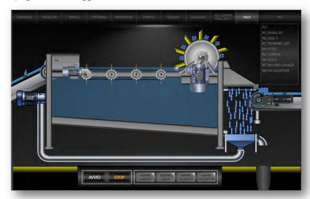
Il lavaggio, secondo la nostra simulazione, si attiva quando i fiocchi di PET, raggiunto l'ingresso del macchinario, vengono rilevati da un sensore, che attiva i motori asincroni trifase connessi a cilindri con palette che, ruotando, garantiscono il movimento del PET.
