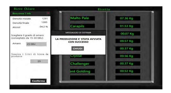
Nella fase di impostazione dei parametri, se viene impostata una gradazione errata per la tipologia di birra selezionata, viene visualizzata una finestra di allarme che, una volta chiusa, va a resettare i parametri selezionati, consentendo anche di cambiare tipologia di birra o semplicemente di cambiare i parametri prima impostati.
