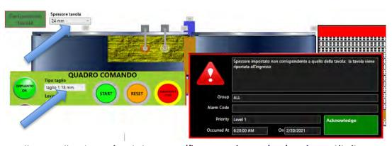
viene data segnalazione e il pannello viene riportato verso l'ingresso in modo che sia sostituito.
