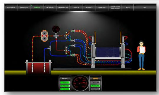
Nella simulazione della pressatura dei cavi di acciaio, viene utilizzata una pressa oleodinamica: la pressa inizia la fase di chiusura quando il braccio che sposta le balle di PET rilascia i cavi di acciaio all'interno della pressa.
