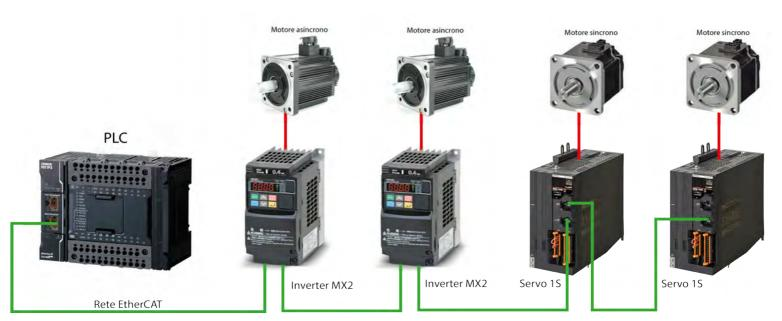
Schema di collegamento EtherCAT motion con PLC
