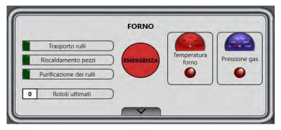
Accedendo al pannello di controllo della sezione di Vacuum Drying, è possibile visualizzare le tre spie che indicano i tre stati principali della macchina e un indicatore dei rotoli ultimati, oltre agli indicatori della temperatura del forno e della pressione del gas e ad un fungo di emergenza.
