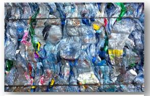
FIGURA 4 TIPICA BALLA DI PET CON FILI METALLICI
