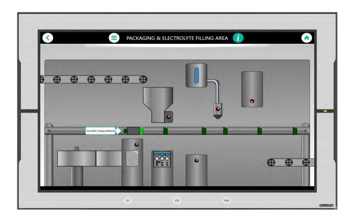
In questa sezione di Packaging & Electrolyte Filling, come suggerisce il nome, avviene il processo di impacchettamento in cui viene inserito il jelly roll nell'involucro metallico e il processo di riempimento dell'elettrolita, oltre alla saldatura dei terminali della batteria.
