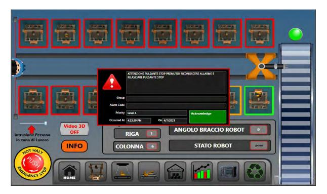
Per simulare lo stato di emergenza è stato utilizzato uno slider che se incrementato muove un operatore all'interno della zona di lavoro del Robot, Area di pericolo per una persona. Se l'operatore oltrepassa la barriera ottica il sistema va in stato di Emergenza e tutte le parti in movimento vengono immediatamente fermate.
