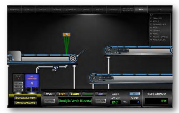
Nella simulazione La Cernita delle bottiglie avviene mediante un soffiatore che si attiva in base al colore della bottiglia di PET individuata dal sensore ottico.
