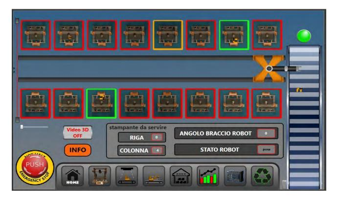
Con lo slider posto sotto la prima stampante in basso a sinistra, è possibile simulare una eventuale intrusione da parte di un operatore nella zona di lavoro del robot. Ciò provoca l'arresto immediato del sistema, poiché può essere molto pericolo per l'operatore se il robot continuasse a funzionare normalmente.
