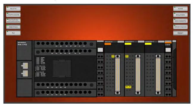
E' stato utilizzato un PLC NX1P2-9024DT1, con 3 moduli ingresso/uscita ID6142-6 e OD6256-5 e HMI NA5-15W101.
