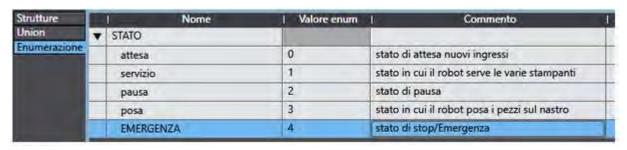
Il Programma AUTOMATIC inserisce gli indici delle stampanti che hanno finito di lavorare, in una coda Stack da cui nello stato di attesa vengono prelevati per comunicare al robot in quale posizione deve portarsi. Le varie posizione delle stampanti sono contenute in un array, e vengono passate al Blocco Funzione MC\_Move tramite gli indici prelevati.
