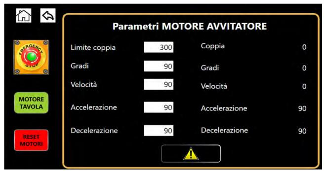
Figura 14: Parametri avvitatore.
