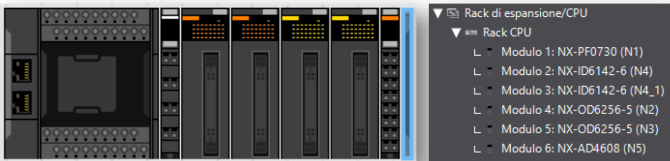
FIGURA 9 - LA VISTA DEL RACK CPU E DEI MODULI AGGIUNTIVI UTILIZZATI
