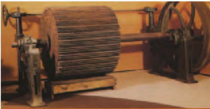
FIGURA 3 CILINDRO DI LEGNO DELLA "PILA OLANDESE" O "PILA A CILINDRO", RICOPERTO DA LAME D'ACCIAIO SPORGENTI
