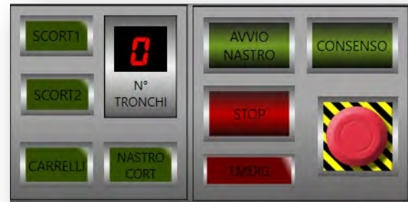
FIGURA 10 - LA PULSANTIERA DELLA SCORTECCIATRICE
