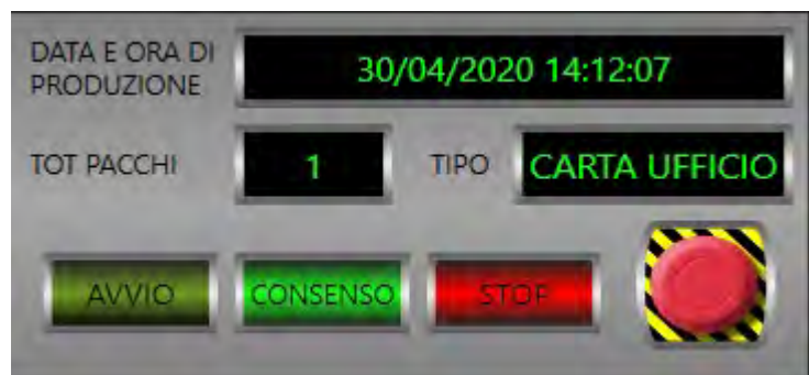
FIGURA 14 LA PULSANTIERA DELLA PRESSA
