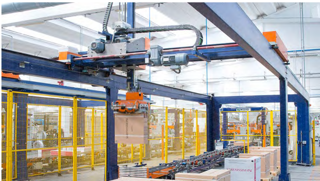
Figura 2.2.1: Linea di pallettizzazione Sacmi
