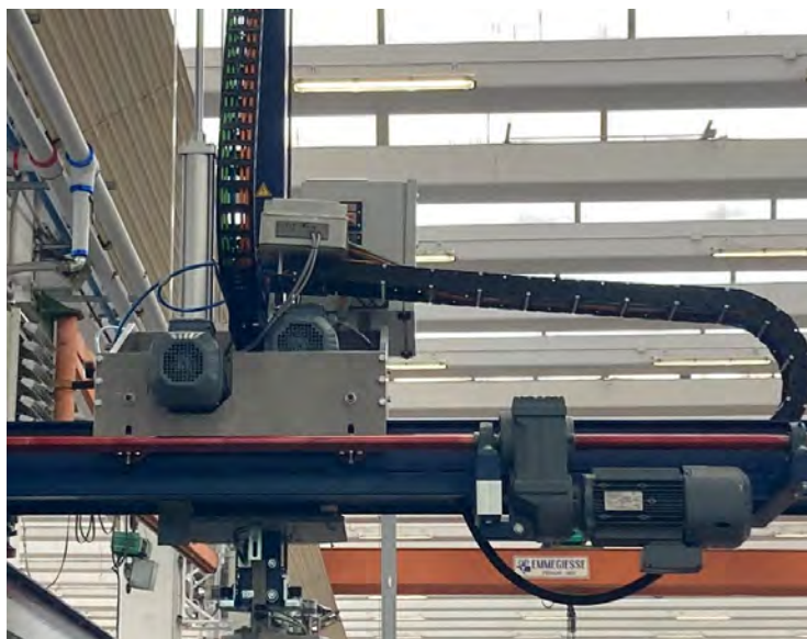
Figura 2.2.2_c: sistema cartesiano di movimento
