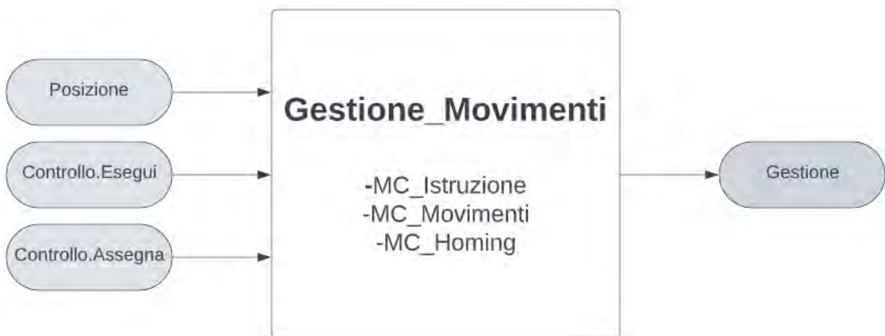
Fig.38: Rappresentazione I/O del Programma Gestione_Movimenti
