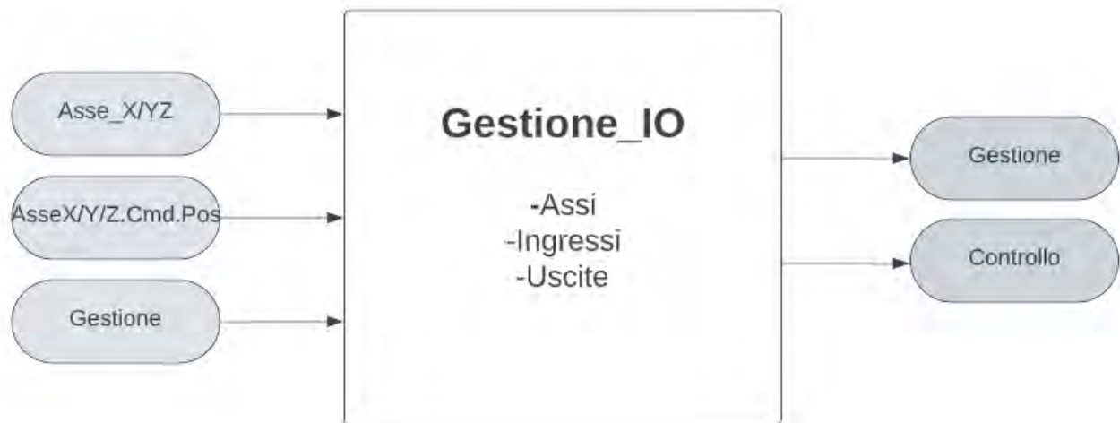
Fig.41: Rappresentazione I/O del Programma Gestione_IO
