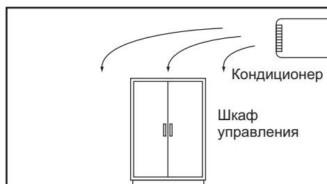
Охлаждение воздуха в помещении
