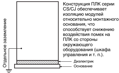
Пример: изоляция и заземление корпуса
