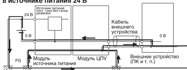
Схема электропроводки, приводящая к замыканию в источнике питания 24 В
