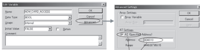
Адрес A34313 закрепляется за внутренней переменной логического типа с именем NOW_CARD_ACCESS.
