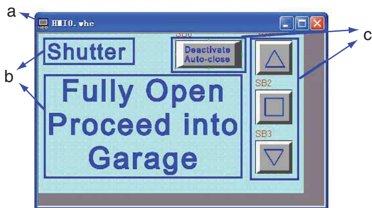
а Экран б Компоненты «Статический текст» с Компоненты «Установка состояния бита»
