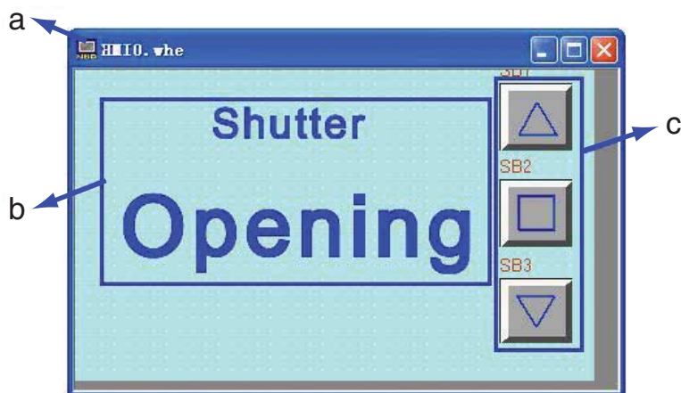
а Экран б Статический текст с Компоненты «Установка состояния бита»
