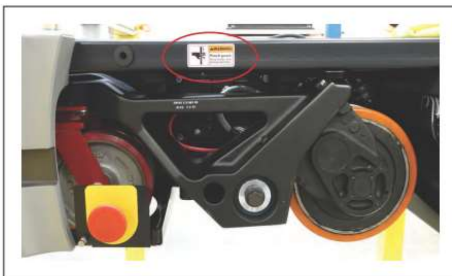
Ilustracja 2-6. Usunięta obudowa boczna – Odsłonięty silnik i zespoły silnika
