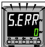
← Se l'impostazione del parametro "Tipo di ingresso" non è adeguata al tipo sensore collegato, lampeggerà sul display la scritta S.ERR (errore di ingresso) come mostrato nella figura a sinistra.
