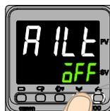
Se richiesto, usare il tasto (Modo) e i tasti su e giù per ripetere i passi 2 e 3 e impostare ON/OFF per a2l t (A2LT) (Allarme 2 Latch), a3l t (A3LT) (Allarme 3 Latch), e a4l t (A4LT) (Allarme 4 Latch). (Il numero di allarmi supportati dipende dal modello del termoregolatore. Alcuni parametri degli allarmi potrebbero non essere visibili)
