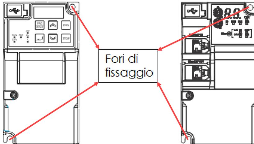
**Figura 1: vista frontale e fori di fissaggio**
