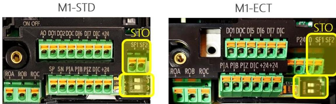
**Figura 18: disposizione DIP switch SW9 e terminali per STO**
