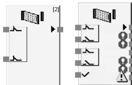
Bloque de funciones de monitorización de puerta de seguridad con ajustes predeterminados
