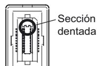
**5. Deslice el controlador de sensor para insertarlo en el conector de la unidad Controller Link.**
