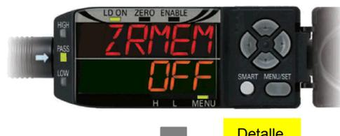
Configuración del valor de reset a cero para la función de reset a cero.
