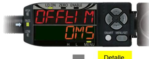
Configuración del modo de almacenamiento del valor de reset a cero "zero-reset" (de manera permanente o volátil).
