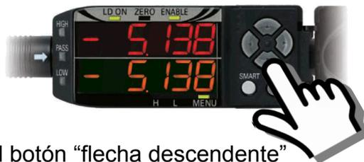
Pulse el botón “flecha descendente” durante 3 segundos. Para volver a desactivar, pulse simultáneamente la flecha ascendente y la descendente durante 3 segundos.
