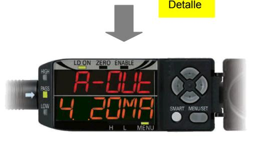
Configura el comportamiento de la salida analógica en caso de que el sensor esté en estado de error (la respuesta no consigue obtener un valor de medición. Display: Oscuridad.) Consulte la página 12.
