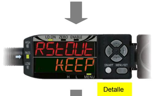
Configuración del valor de fijación para la salida analógica (solamente será válido si RStOUT se ha configurado como "Clamp").
