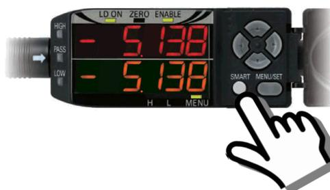
Pulse el botón SMART durante 1 segundo para activar la función Ajuste inteligente individual, durante dos segundos para activar la función Ajuste inteligente múltiple y durante 4 segundos para activar la función Ajuste inteligente activo.
