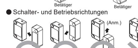
Anm. Stellen Sie bei Verwendung der Betriebsrichtung entlang der Sensorfläche sicher, den Schalter und den Betätiger so einzubauen, dass sie nicht von der Seitenkeule beeinträchtigt werden.
