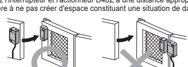
(12) Lorsque deux interrupteurs ou plus sont montés côte à côte, ils doivent être éloignés de 50 mm minimum dans les directions X, Y et Z.
