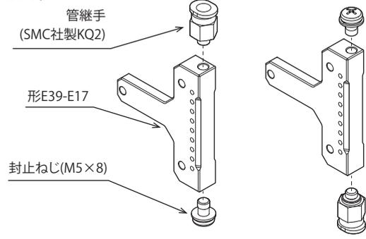
2. センサに取り付けて、チューブを挿入してください。ユニットはセンサの左右どちらの面にも取り付けできます。
