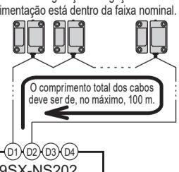
(5) Desligue o G9SX-NS□ da fonte de alimentação sempre que substituir o D40A. Os dispositivos ligados ao G9SX-NS□ poderão funcionar de forma inesperada.
