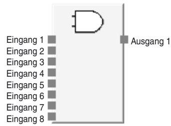
Logikfunktion AND mit der maximal möglichen Zahl von Eingängen
