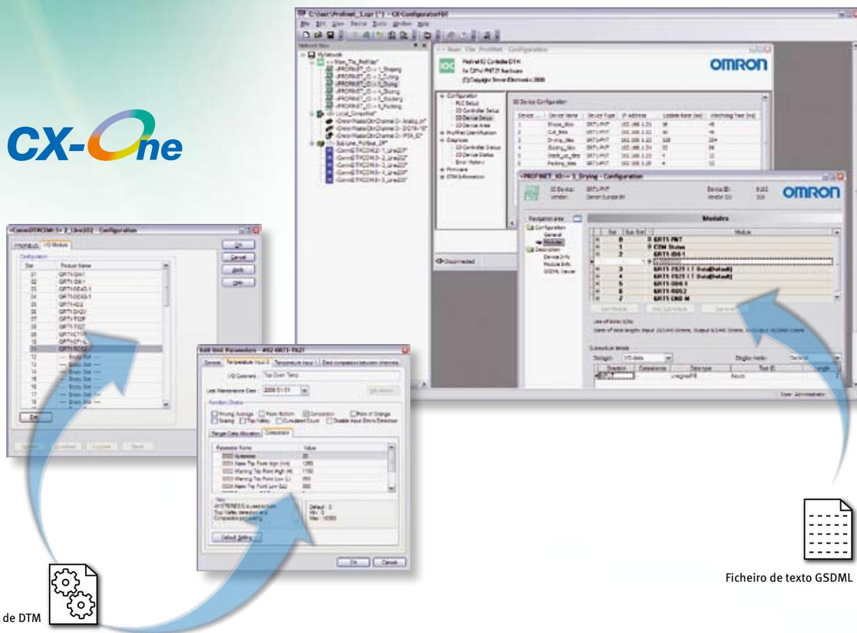
Os produtos da Omron suportam o PROFINET-IO para comunicações master-slave cíclicas de dados em tempo real, de acordo com as necessidades da automatização industrial em geral. O PROFINET-IO, a variante PROFINET mais universal, é semelhante a comunicações de redes de campo e oferece maior flexibilidade, sendo simultaneamente, fácil de utilizar.
