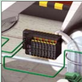
Built-in switch with MRP client function. Wbudowany przełącznik z funkcją klienta protokołu MRP.
