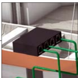
Jeden przełącznik pełniący rolę menedżera MRP steruje pierścieniem redundanym zgodnym ze standardem PROFINET
