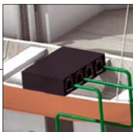
En switch som MRP-styrer kontrollerer PROFINET-kompatibel redundant ring.
