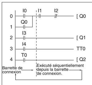
ZEN exécute l'ensemble du programme à contacts (jusqu'à 96 lignes) de la première à la dernière ligne simultanément. Chaque ligne est exécutée de gauche à droite, en commençant par la barre de connexion gauche.
