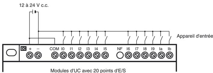
**Remarque :** Dans le cas d'une connexion à une borne commune positive (+), Ia et Ib ne peuvent pas être utilisés comme entrées analogiques.
