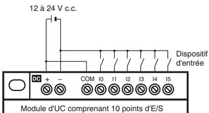
**Remarque :** Dans le cas d'une connexion à une borne commune positive (+), I4 et I5 ne peuvent pas être utilisés comme entrées analogiques.
