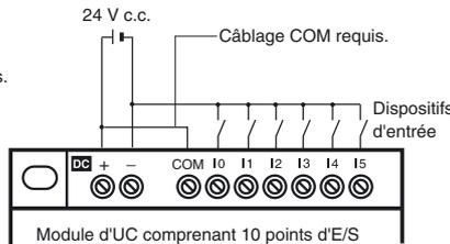
**Remarque :** I4 et I5 (Ia et Ib pour les modules d'UC comprenant 20 points d'E/S) ne peuvent pas être utilisées comme bornes d'entrée analogiques.
