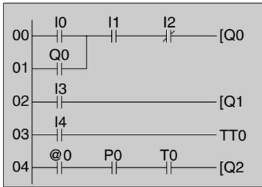
Temps d'exécution du programme à contacts =  $(30 \times 5) + (4 \times 3) + 15 + 4 + 7 = 188 \text{ (}\mu\text{s)}$
