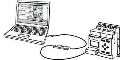
**Remarque :** Pour les ordinateurs portables ne disposant d'aucun port série RS-232C, raccordez l'ordinateur au ZEN en connectant un câble de conversion USB-série OMRON S1W-CIF31 au câble de connexion ZEN-CIF01.
