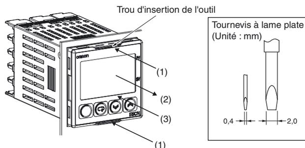
1. Insérez un tournevis plat dans les deux trous (un en haut et l'autre en bas) pour relâcher les crochets.
