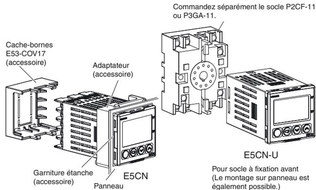
1. L'adaptateur de montage sur panneau est également compris avec le E5CN-U. Le modèle E5CN-U n'est pas doté d'une garniture étanche.
