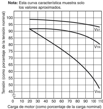
**Nota:** Para pérdida de fase de fase R. V<sub>ST</sub>, V<sub>TR</sub> y V<sub>RS</sub> indican la tensión de terminal del motor en pérdida de fase.
