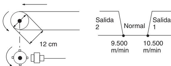
$$\text{Velocidad (m/min)} = 5654,866... \times \text{Frecuencia de entrada (Hz)}$$
