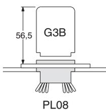
**Nota:** Al montar el PF083A, coloque abajo la pestaña de bloqueo en el carril.
