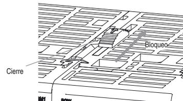
3. Coloque la junta de protección en la abertura del conector de la unidad en el extremo izquierdo del EJ1.
