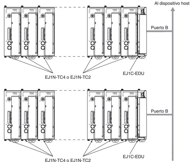
Se pueden conectar hasta 64 Unidades de Control mediante la instalación distribuida.
