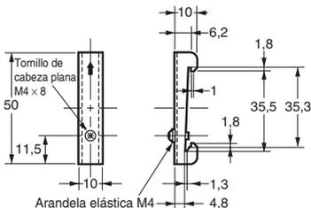
**Nota:** Se incluyen dos tornillos con EJ1C-EDU para el tope final. Coloque siempre dos tope finales a ambos lados.
