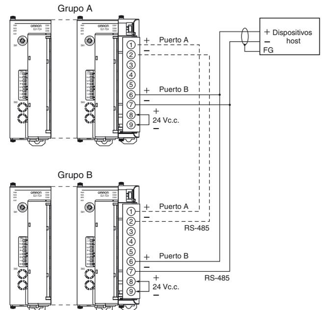
**Nota:** Cablee la línea de puntos cuando se realicen configuraciones para todas las unidades distribuidas desde un solo conector de puerto A.
