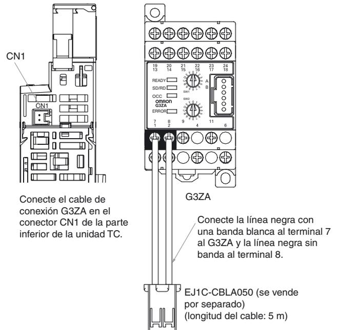
Conecte el cable de conexión G3ZA en el conector CN1 de la parte inferior de la unidad TC.
