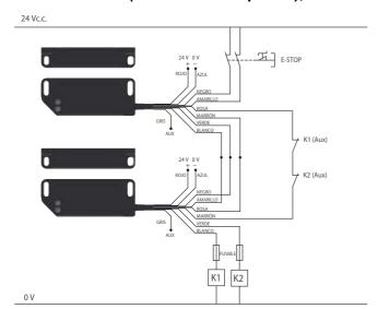
Dos interruptores conectados en serie para proporcionar salidas de seguridad de doble circuito a contactores de máquina.
