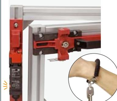
La empuñadura de corredera está asegurada en la posición que se muestra en la ilustración. Si un trabajador lleva consigo el pasador de bloqueo, no quedará atrapado en el interior del área peligrosa por la acción de otra persona.
