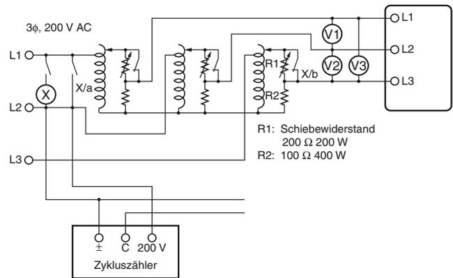
**Q** Überspannungserkennung bei Überschreitung des Überspannungs-Einstellwerts durch nur eine Phase
