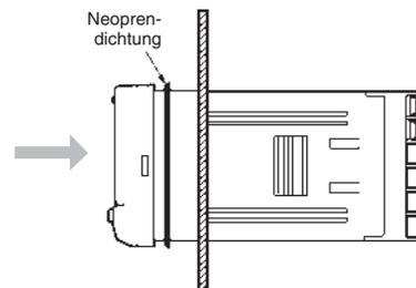
3. Führen Sie den Adapter in die Nuten auf beiden Seiten der Gehäuserückseite ein und drücken Sie ihn anschließend zur Gerätevorderseite, bis diese an der Oberfläche der Schalttafel anliegt.
