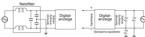
3. Verlegen Sie die Verkabelung zum Klemmenblock des Geräts zur Vermeidung von induktiven Störeinstrahlungen räumlich getrennt von Starkstromleitungen bzw. Hochspannungsleitungen. Verlegen Sie die Kabel nicht parallel zu/mit Kabeln wie Netzleitungen. Weitere Maßnahmen zur Reduzierung von induktiven Störungen sind das Verlegen der Kabel in separaten Kanälen oder die Verwendung von abgeschirmten Kabeln.
