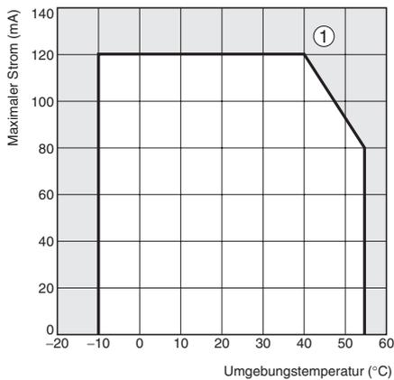
**Hinweis:** 1. Die oben angegebenen Werte wurden unter Testbedingungen bei Standardmontage erzielt. Die Reduktionskurve verändert sich mit den Montagebedingungen. Achten Sie auf die entsprechende Einstellung.
