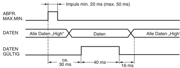
Die Daten werden ca. 30 ms nach der steigenden Flanke des ABFRAGE-Signals gesetzt und das DATEN-GÜLTIG-Signal wird ausgegeben.
