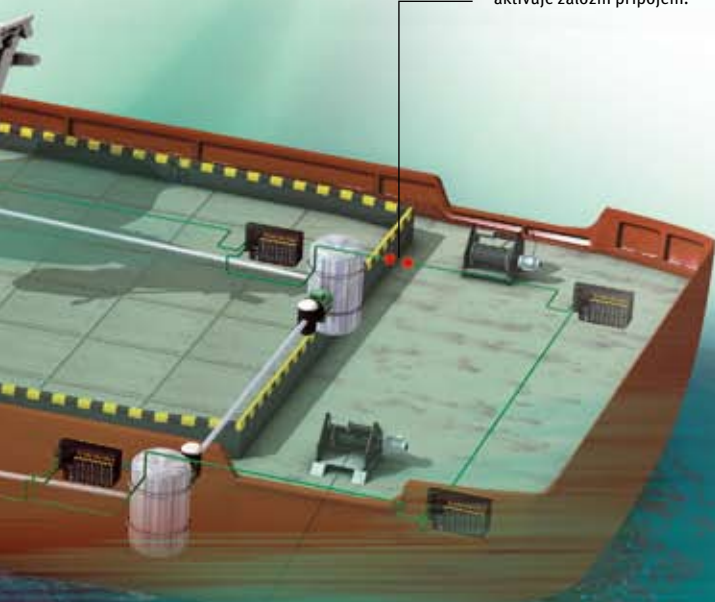
Klientská zařízení MRP hlásí přerušení komunikace správci MRP, který v průběhu milisekund aktivuje záložní připojení.
