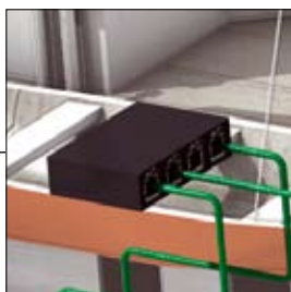
Jeden switch jako správce MRP řídí redundantní okruh odpovídající standardu PROFINET.
