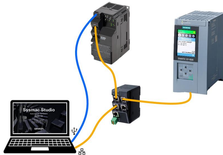
Figura 1: Configurazione HW con Switch Ethernet
