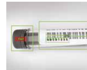
Detecção de cor e leitura OCR
