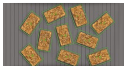
Rilevamento prodotti: 10 pezzi con rotazione < 200 ms
