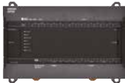
30, 40 veya 60 G/Ç Noktası ile CPU ünitesi
