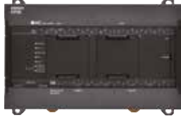
30, 40 veya 60 G/Ç Noktası ile CPU ünitesi
