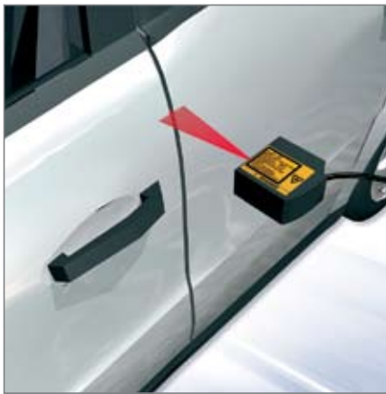
▲ Otomotiv endüstrisinde hassas boşluk ölçümü
