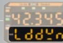
Utrustad med en funktion för laserlivstidsövervakning som varnar för laserförsämring.
